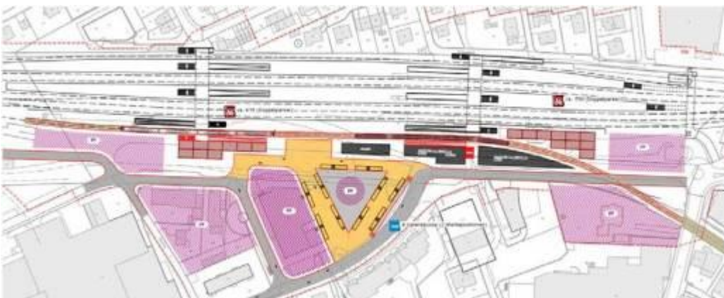
Abbildung 12: Kombination Seetalbahn «Hausperron» mit einem Bushof mit Inselperron
