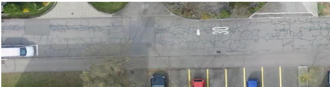
3. Bei den östlichen Etappen, welche in den Jahren 2017 und 2022 saniert wurden, stellte sich heraus, dass alle Randabschlüsse erneuert bzw. neu einbetoniert werden mussten.
